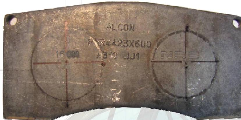
**Percez les tôles support de plaquettes à l'aide d'un foret de diamètre 12 mm sur une profondeur TOTALE de 4mm.**
